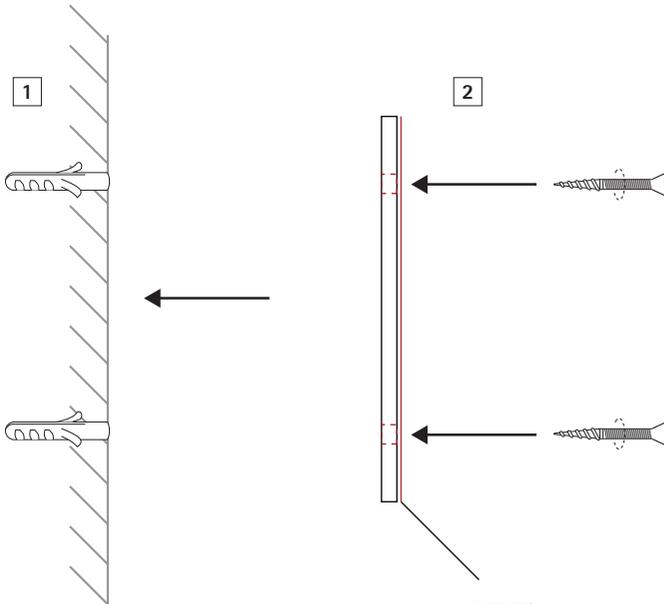
Bohrungen unter Zuhilfenahme der Montageplatte platzieren.
